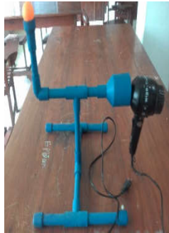
Gambar 7. Alat Demonstrasi Hukum Bernoulli Menggunakan Bola Pimpong dan Hairdryer
