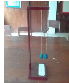
Gambar 8. Alat Demonstrasi Hukum Bernoulli Menggunakan Dua Buah Bola Yang Digantung
