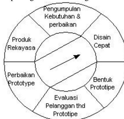
Gambar 3.2: Tahapan-tahapan dalam metode prototyping
