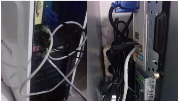
Gambar 15 Menghubungkan Kabel UTP Ke Komputer
