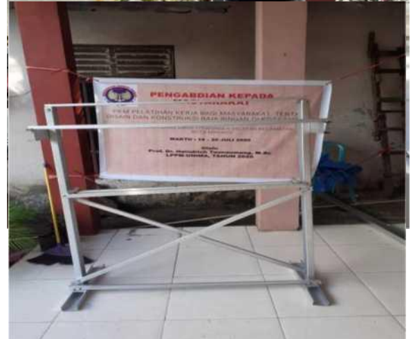
Gambar 3.14 Instruktur selesai memasang skor gantungan handuk untuk penguatan (tidak goyah)
